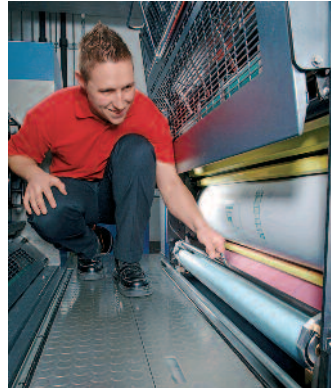
Tuchbasierte Waschsysteme bieten Komfort und weniger Schmutz und sind an der Rapida 105 Standard.
